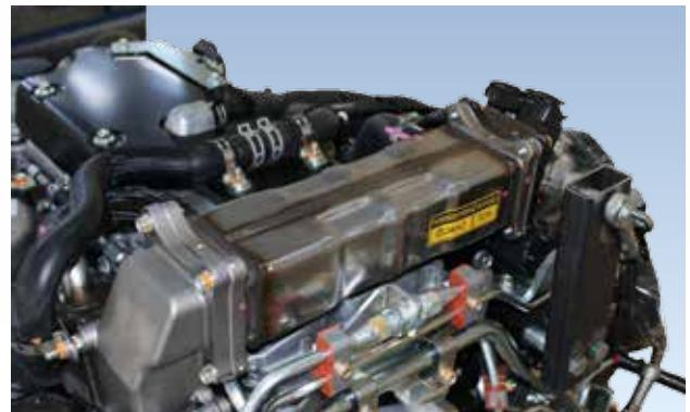
Glavni problem turbo motora je u poteškoći obezbeđenja efikasnosti pri niskim obrtajima motora, jer u takvim uslovima, izduvni gasovi nemaju dovoljnu energiju za pogon turbine s visokom inercijom koje su predviđene za rad u srednjim i visokim režimima.
