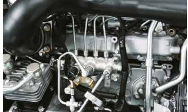
**Sistem ubrizgavanja pod visokim pritiskom common-rail** bolji je od tradicionalnih sistema jer predstavlja jedini način regulacije ubrizgane količine goriva i vremena paljenja na tačan i fleksibilan način.
