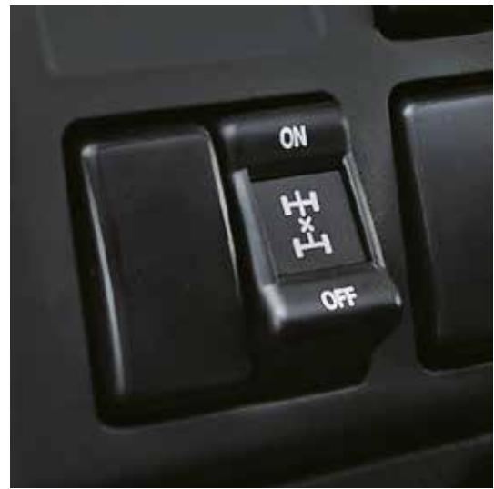
Jednim tasterom moguće je blokirati zadnji diferencijal, kako ne bi dolazilo do proklizavanja jednog od točkova što je idealno na klizavom kolovozu
