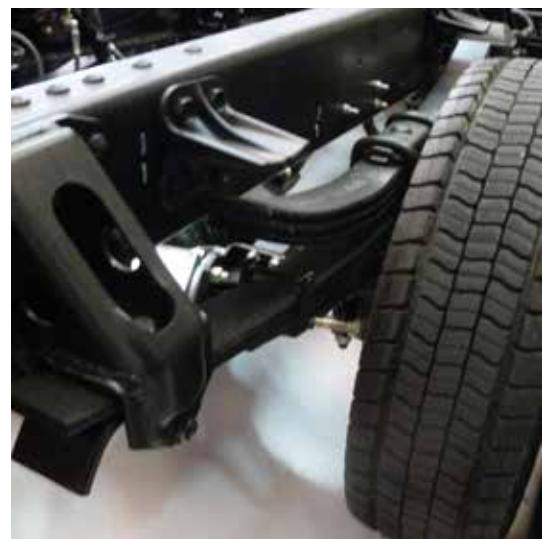
F11 SM – Mehaničko oslanjanje sadrži elastičnu spojnicu za prednju i zadnju osovinu
